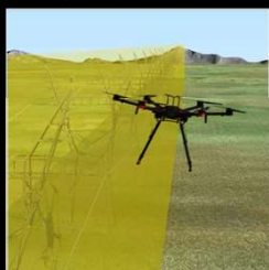
③送電鉄塔に沿ったジオフェンスの実装
